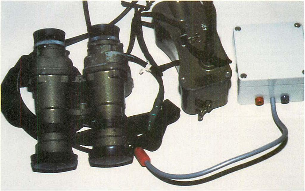
Abb. 2. Nachtsichtgerät russischer Bauart mit Restlichtverstärker
