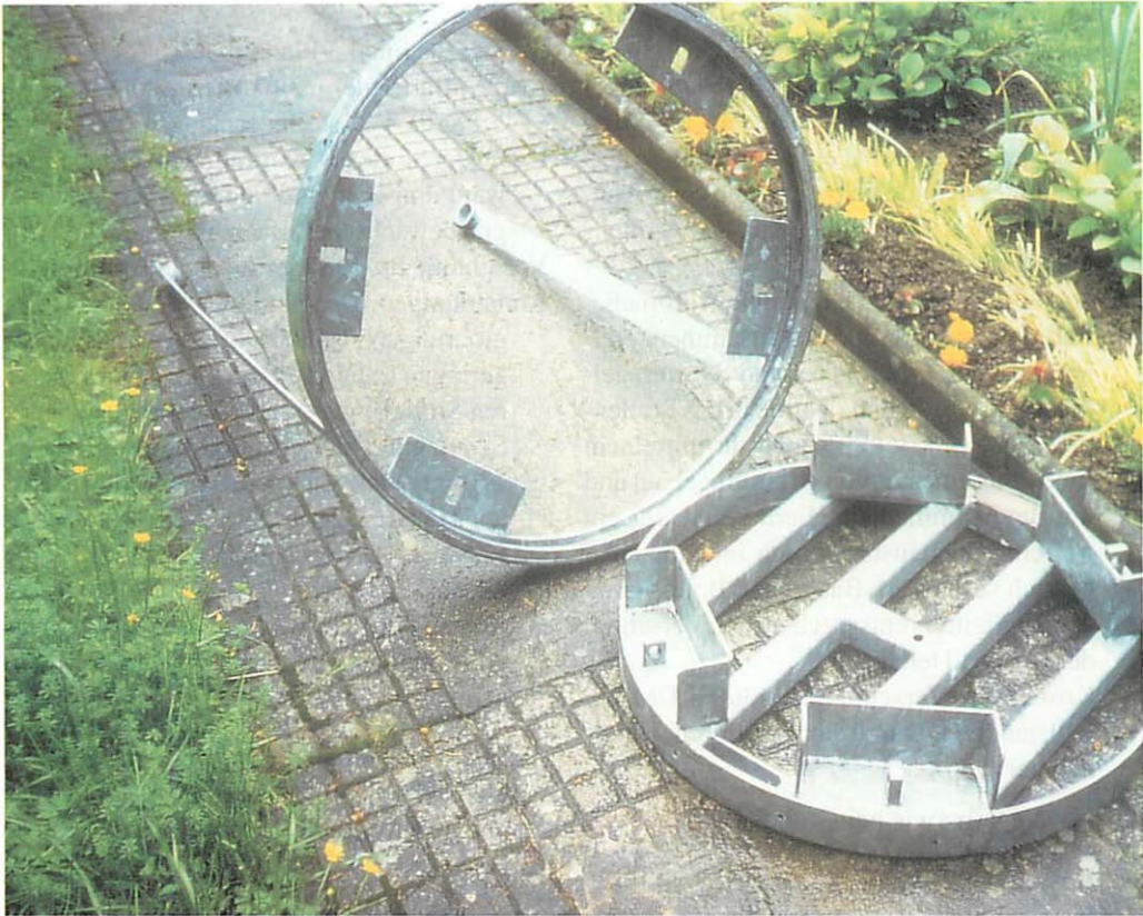
Abb. 8. Rundgitter samt Halterungsrahmen vormdem Einbau in den Eingangsbereich der Eisenerzgrube „Helene“ in einem Ortsteil von Weilburg. Aufn.: JOSEF KOETTINIZ.
