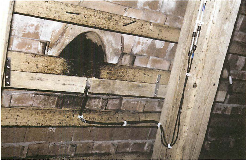
Abb. 3. Infrarotlichtschranken unterhalb der Ausflugsiegel. Durch paarweise Anordnung läßt sich zwischen Aus- und Einflug unterscheiden. Aufn.: M. KLINGER
