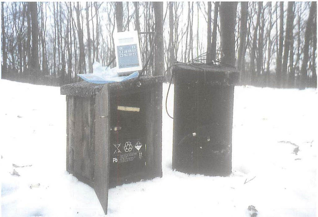
Abb. 1. Schwegler-Fledermauskasten mit angeschlossenem Datenlogger in einem Wald bei Plön. Links eine Vogelkastenattrappe für den Logger und die Batterie. Aufn.: C. HARRJE
