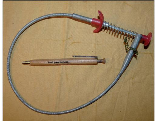
Abb. 1: Flexibler Greifer zur Entnahme von Mulmproben.
