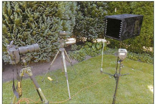
Abb. 4. Aufbau des Flugtunnels mit Blitzgeräten und Fotoapparat.
