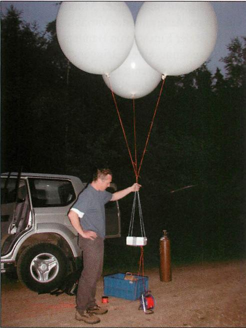
Abb. 2. Helium-Ballons mit Erfassungseinheit.
